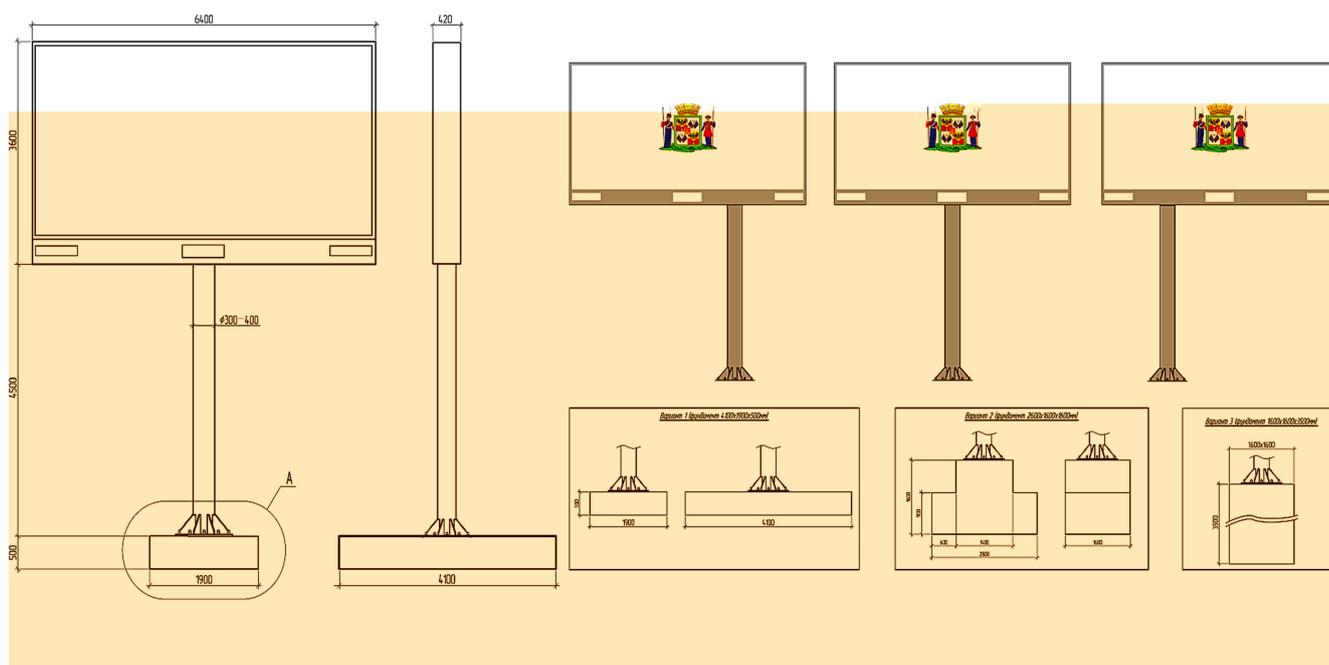
установки рекламной конструкции на заглубленном фундаменте, допускается установка рекламной конструкции без заглубления фундамента, в таком случае конструктивные элементы жесткости и крепления рекламной конструкции должны быть закрыты декоративными элементами).
